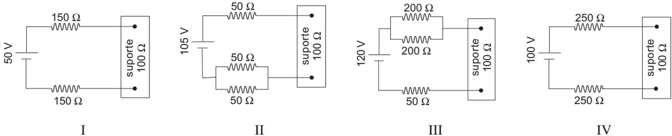
Se a intensidade da corrente elétrica no suporte de eletroforese for superior a 0,2 A, a quantidade de calor dissipada no suporte será capaz de promover a desnaturação térmica das proteínas a serem separadas.
