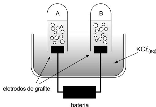
Nesse processo, são obtidos dois gases e uma nova solução com características diferentes da original.
